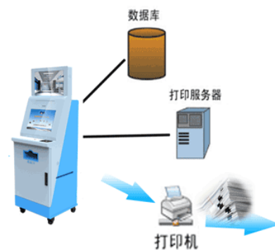
图 1 自助服务终端机基本工作原理示意 (此图仅做示意)
