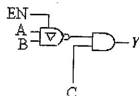
3、(5分) 在图示电路中，已知与非门的输入电流为  $I_{IL} = -1.0\text{mA}$ 、 $I_{IH} = 20\mu\text{A}$ ，输出电流  $I_{OL(\text{max})} = 16\text{mA}$ 、 $I_{OH(\text{max})} = -0.4\text{mA}$ ，计算门  $G_m$  能驱动多少同样的与非门。
