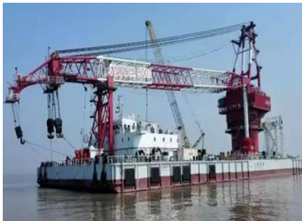
潮间带风机安装平
