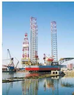
自升式海洋钻井平台
